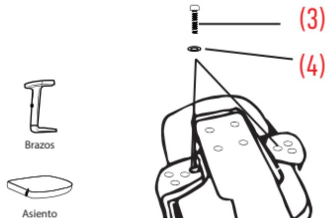
Asegure los 2 brazos al asiento alineando los orificios de ambas superficies. Coloque la arandela luego asegure el tornillo como se muestra en la figura.
