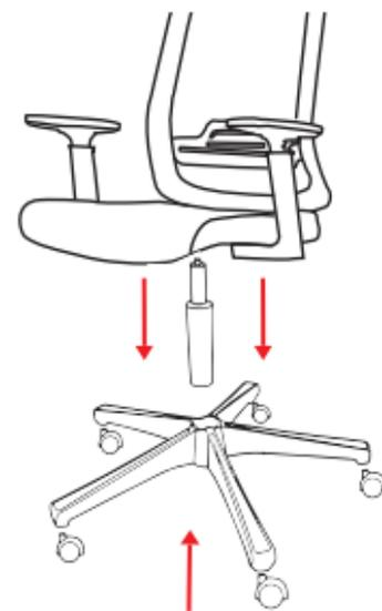
Asegure las 5 ruedas a la base, coloque el neumático, coloque la base al asiento insertando el neumático como lo indica la flecha.
