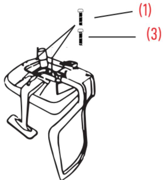
Asegure el mecanismo colocando lo en los orificios del asiento, de manera que la perilla quede hacia el frente.
